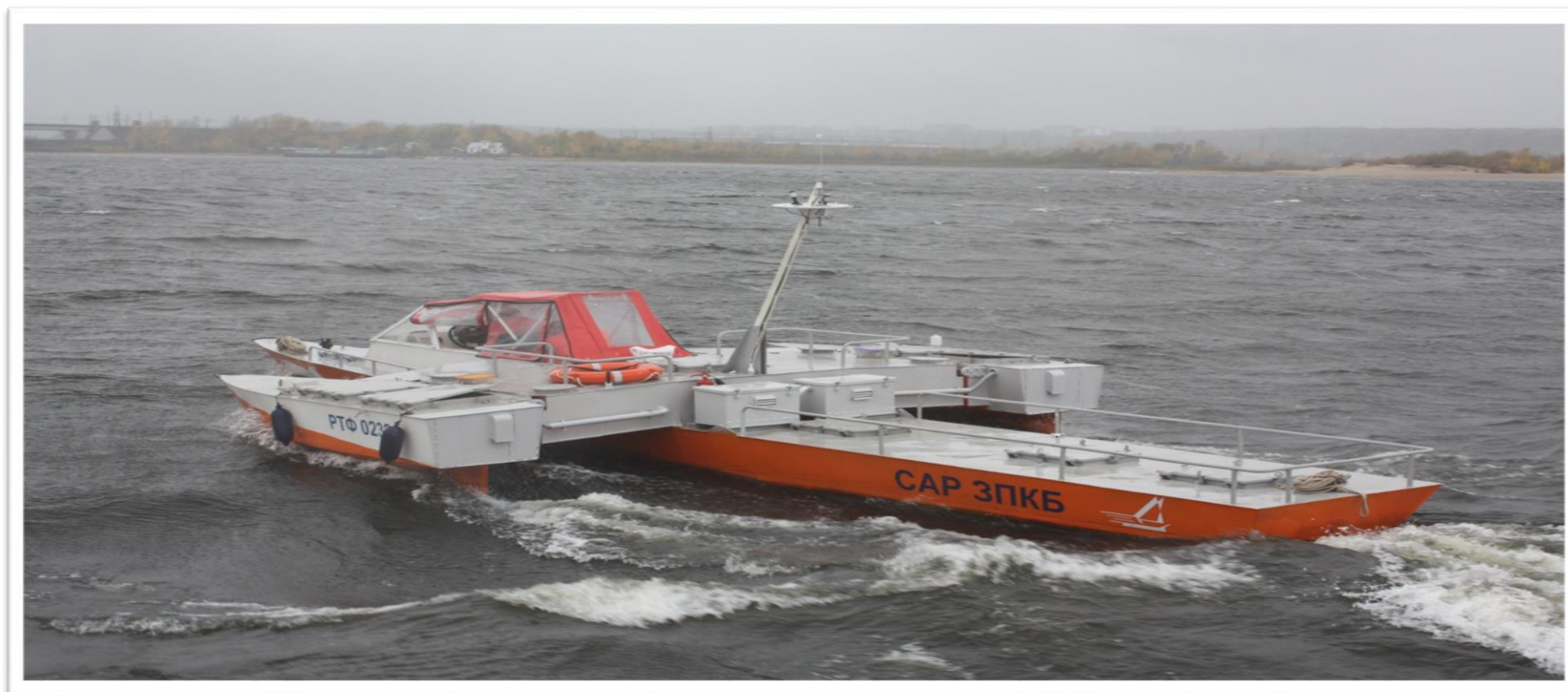
А3. Самоходная модель. Судно с аутригерами (САР)
