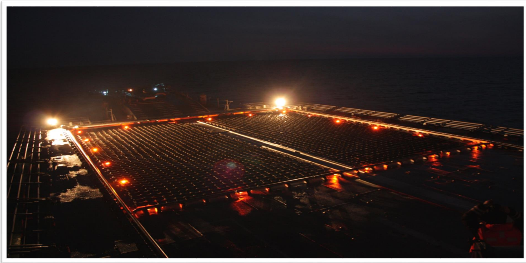
А 21. ВППл корабля проекта 11540 зав. С-402 с включенным светотехническим оборудованием «Тюльпан В1» при взлете и посадке на ВППл ночью
